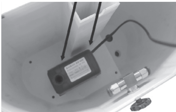
6. Τοποθετήστε την υποβρύχια αντλία στη δεξαμενή.
